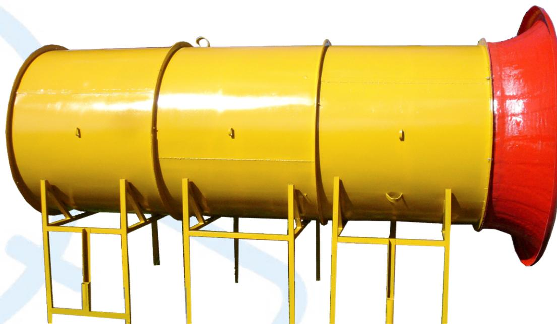
**Стенд аэродинамических испытаний САДИ -1600
