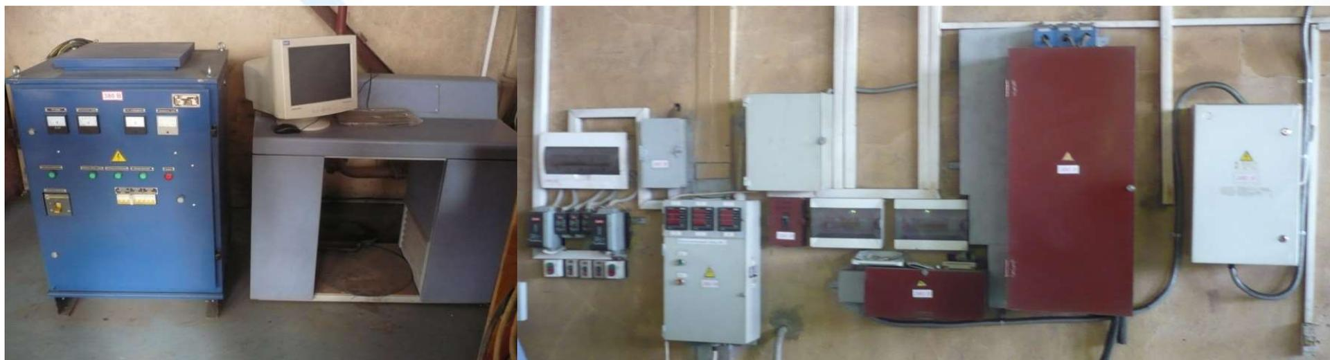
Станция плавного пуска. Стенды с частотным управлением
