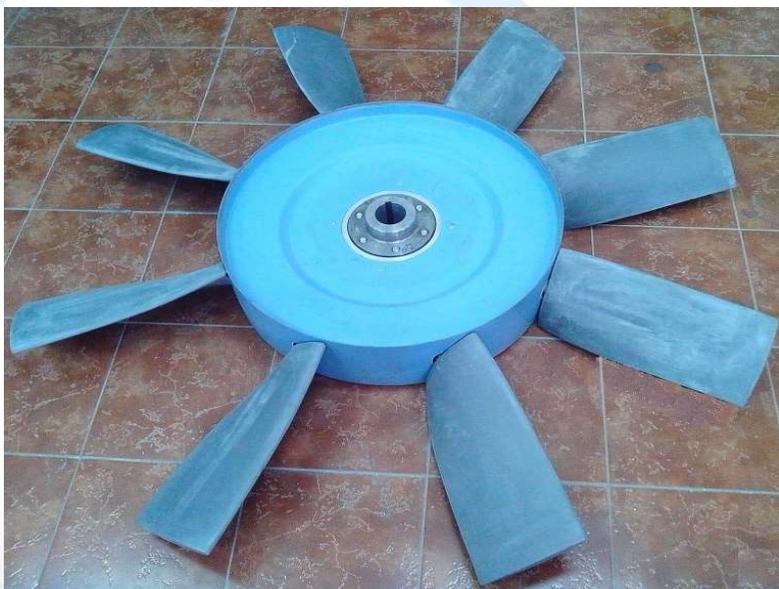
**Установка стеклопластиковых вентиляторных колес повышает надёжность и увеличивает ресурс элементов приводов вентиляторов маневровых тепловозов ТЭМ18.**
